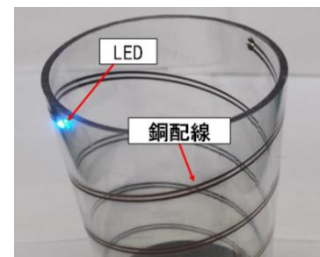
図2. 円柱のポリカーボネート(PC)への銅配線形成サンプル
